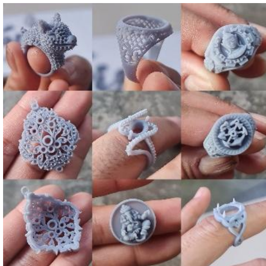
ภาพ 3 ชิ้นงานจากเครื่องพิมพ์ 3 มิติ ELEGOO Saturn 3 Ultra วัสดุเรซินรุ่น Standard Plus
