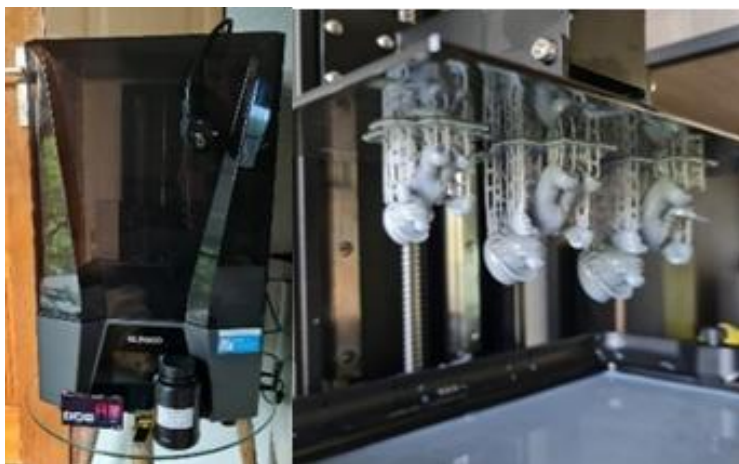
ภาพ 2 เครื่องพิมพ์ 3 มิติ ELEGOO Saturn 3 Ultra พิมพ์ด้วยวัสดุเรซินรุ่น Standard Plus
