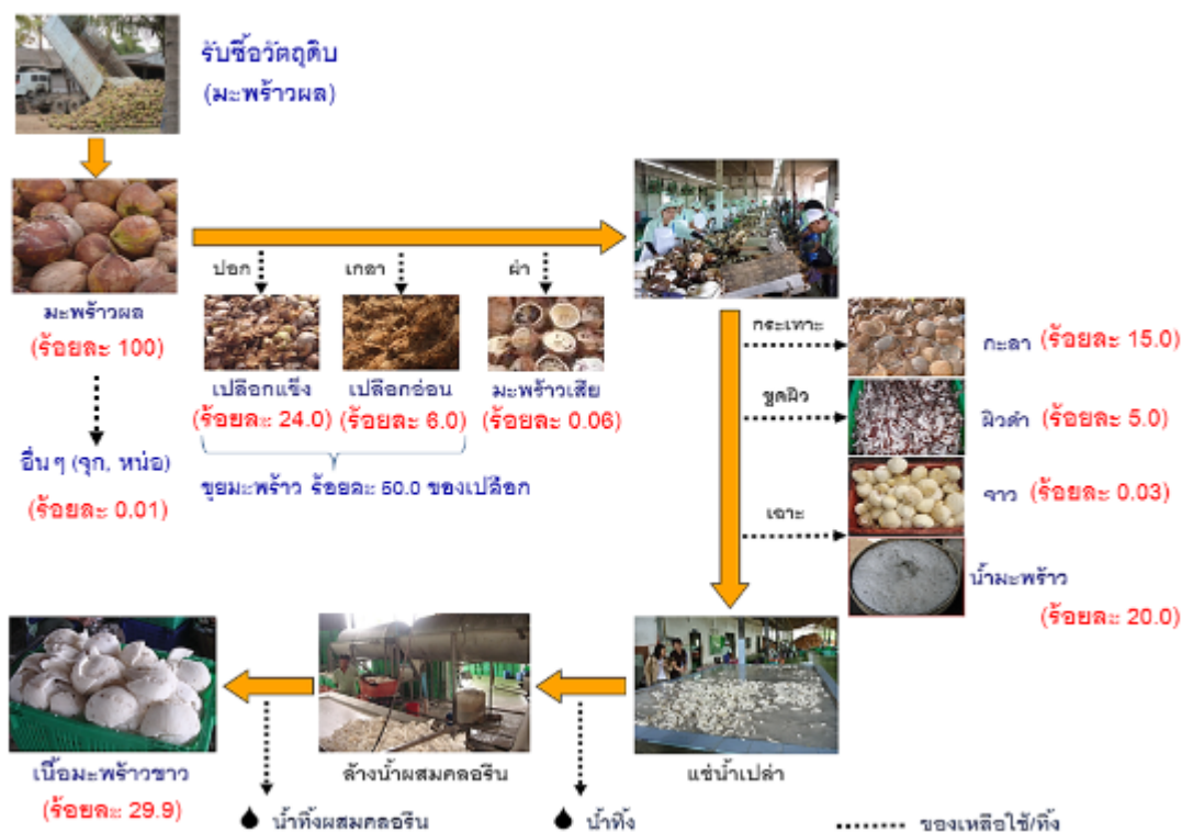
ภาพที่ 2. กระบวนการผลิตเนื้อมะพร้าวขาวและสัดส่วนของเนื้อมะพร้าวขาวและของเหลือใช้ (ปรับปรุงจาก Koonsrisuk et al., 2015)
