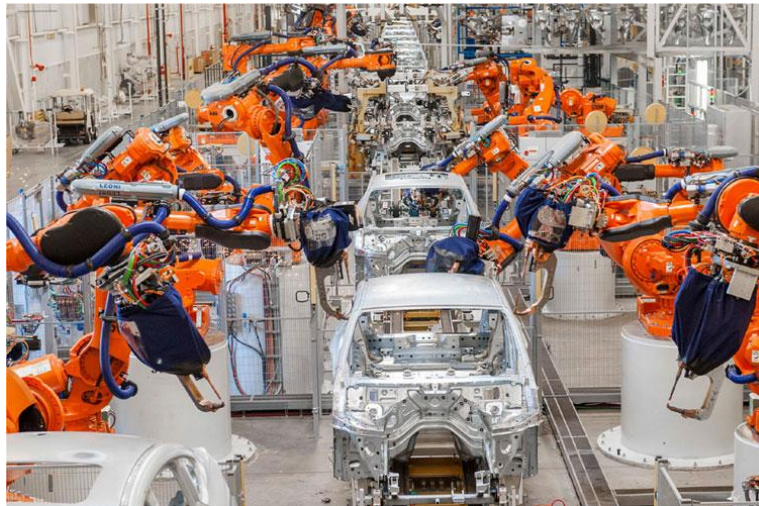
ภาพที่ 5 แสดงระบบผลิตอัจฉริยะแต่ละส่วนของหุ่นยนต์ Kuka ในการประกอบรถยนต์ ที่มา http://itthiritttechnology.com
