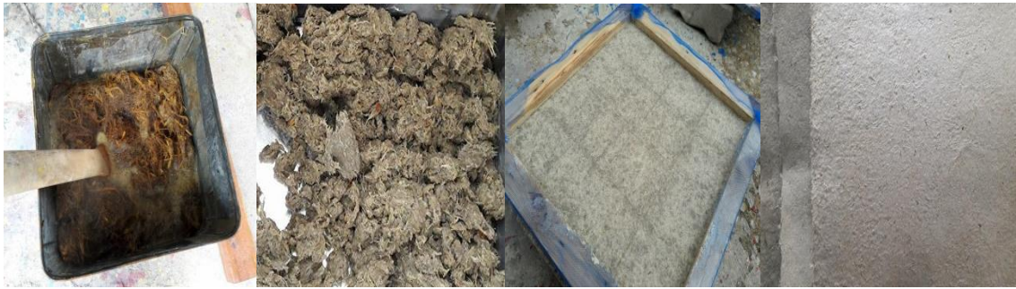
ภาพที่ 2 ขั้นตอนการขึ้นรูปบรรจุภัณฑ์กระดาษจากฟางข้าวแห้งสำหรับผลไม้แช่อิ่ม ที่มา: จุฬาลักษณ์ จารุจุฑารัตน์ (2560, น.96-99)
