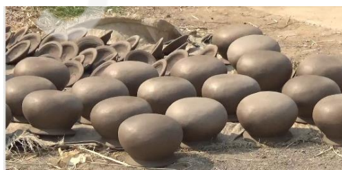
ภาพที่ 3 กระบวนการตากหม้อ
