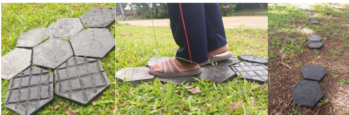
ภาพที่ 2 ตัวอย่างต้นแบบอิฐนาโนจากขยะพอลิเมอร์
