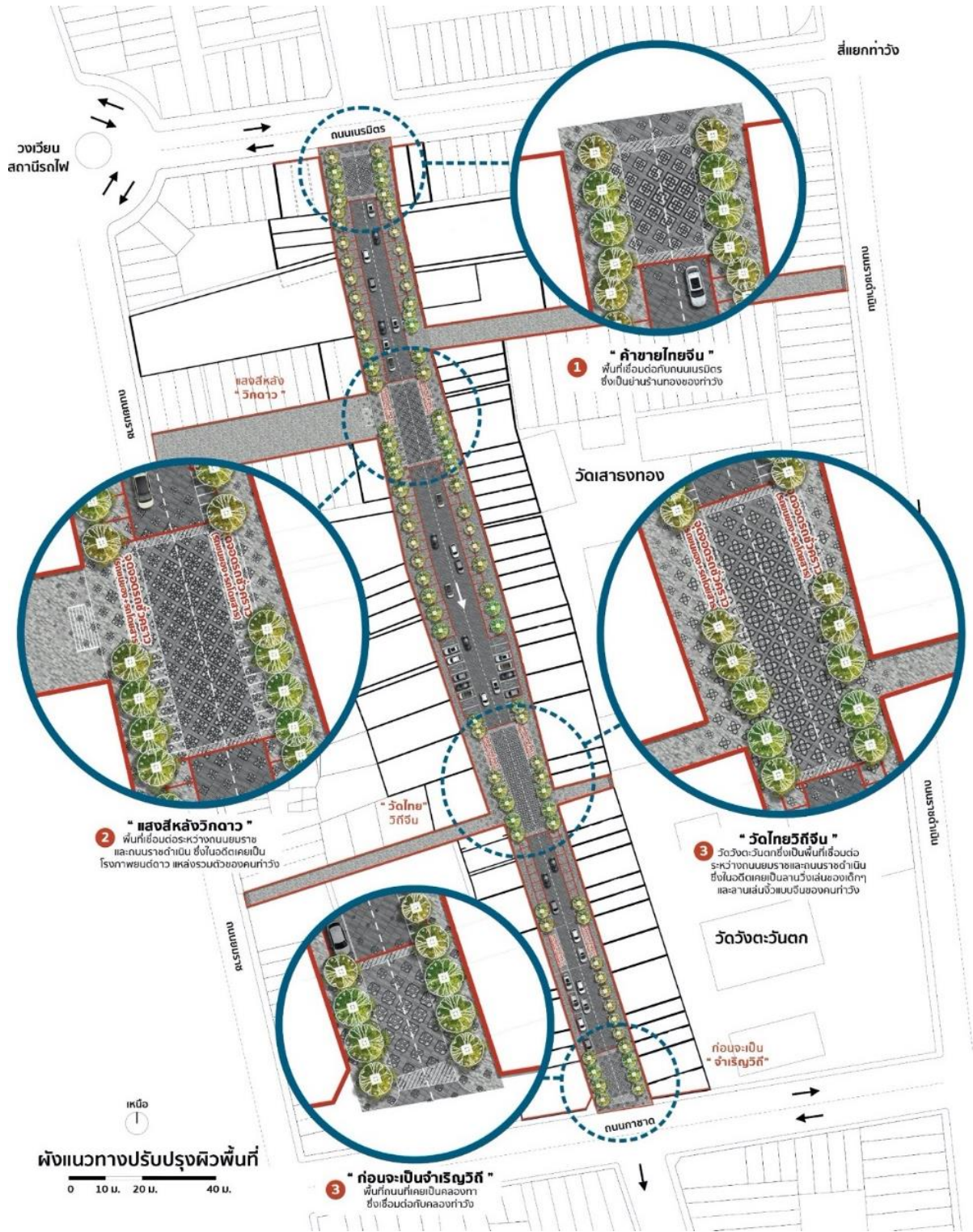
รูปที่ 5 : แบบร่างแนวทางการออกแบบปรับปรุงพื้นผิว (Pavement) ของพื้นที่ถนนเพื่อแบ่งพื้นที่การใช้งานด้วยวัสดุแทนการยกระดับพื้น ให้พื้นถนนแสดงคุณค่าและความสำคัญของย่านท่าวังและถนนจําเรณูวิที 4 เรืองราว
