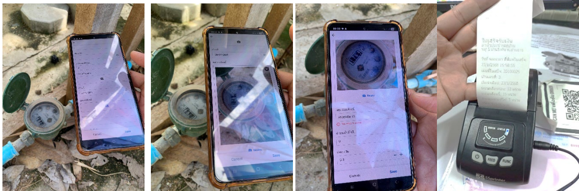
รูปที่ 3 : ระบบที่นำไปใช้จริงในการอ่านเลขจากมิเตอร์น้ำ แสดงผลการใช้น้ำ และพิมพ์เสร็จออกมาได้ทันที
