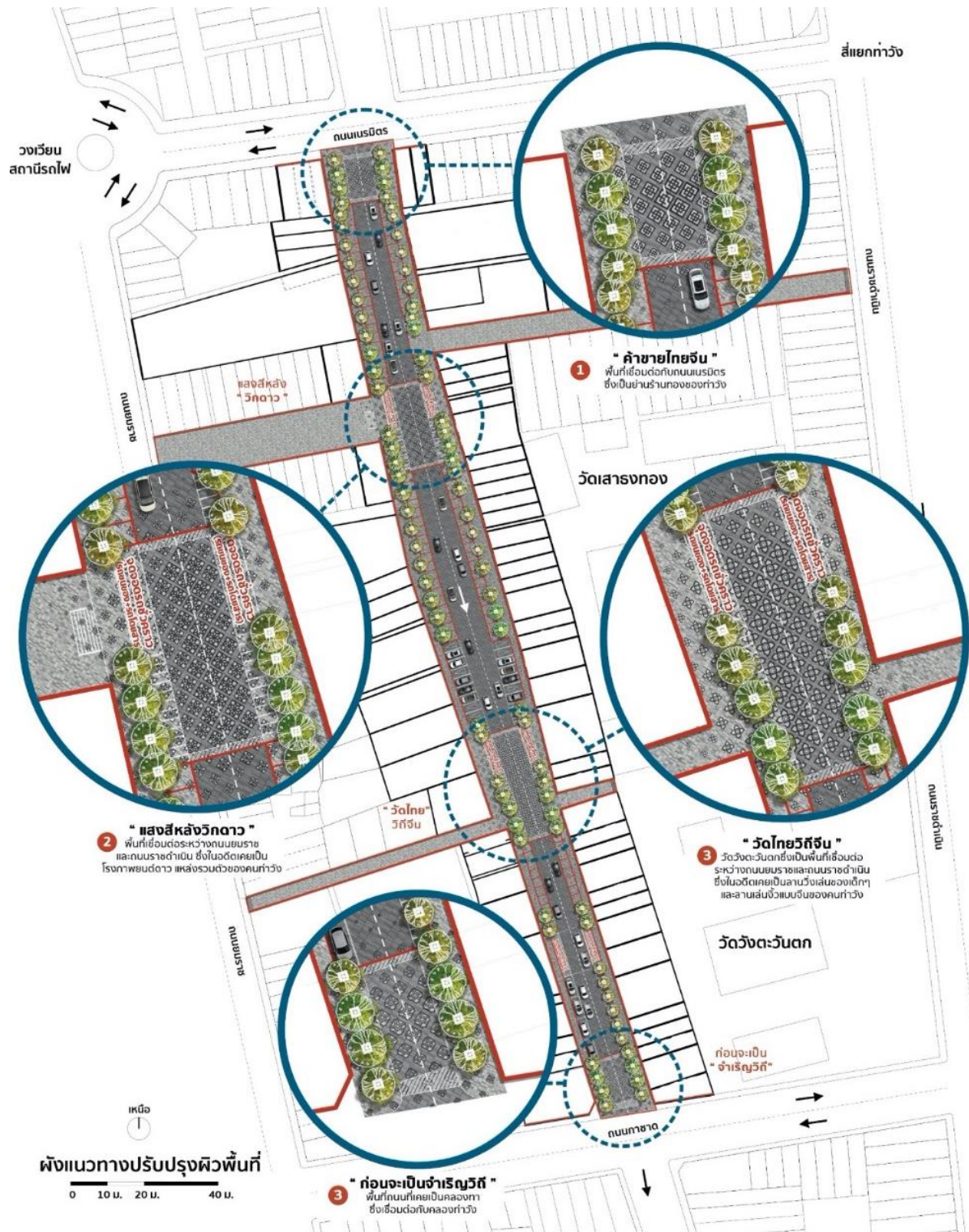
รูปที่ 5 : แบบร่างแนวทางการออกแบบปรับปรุงพื้นผิว (Pavement) ของพื้นที่ถนนเพื่อแบ่งพื้นที่การใช้งานด้วยวัสดุแทนการยกระดับพื้น ให้พื้นถนนแสดงคุณค่าและความสำคัญของย่านท่าวังและถนนเจ้าเจริญวิทย์ 4 เรือราว ที่มา : ผู้วิจัย
