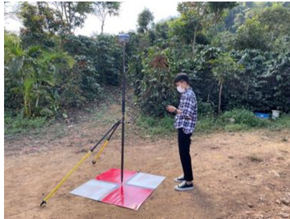
ภาพที่ 6 การสำรวจรังวัดค่าพิกัดของจุดควบคุมภาคพื้นดินและจุดตรวจสอบ
