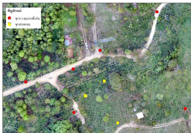
ภาพที่ 5 การกำหนดจุดควบคุมภาคพื้นดินและจุดตรวจสอบ
