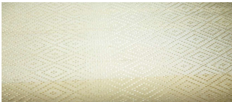
ภาพที่ 5 ผ้าลายลูกแก้ว ด้านบนขณะทอบนก็ทอผ้า พิมพ์ 5 เขา 2 เอื้อ
