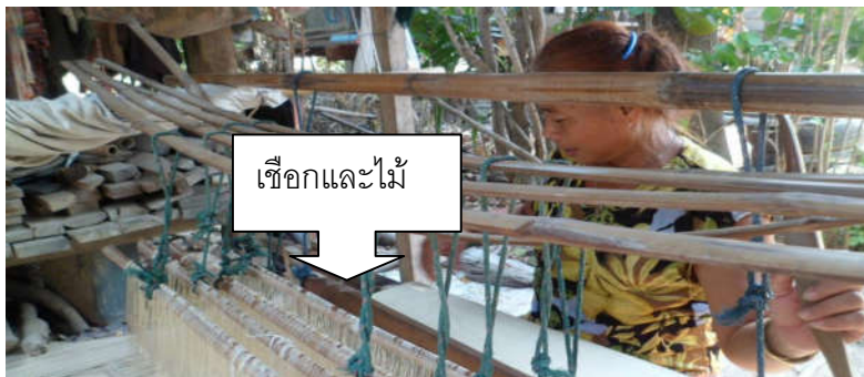
ภาพที่ 2 การใช้ไม้ที่ที่มีความยืดหยุ่นโยงเขาพิมด้วยเชือกเพื่อช่วยในการเหยียบและยกตะกอ
