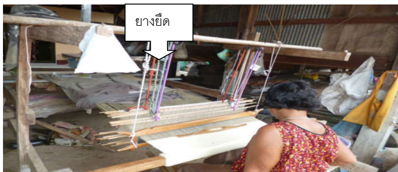
ภาพที่ 8 การทอผ้าลายลูกแก้ว พิมพ์ 5 เขว 2 เอื้อ เขาหนาอยู่หลังเขาชิดโดยใช้ สายยางมัดให้ความยืดหยุ่นเพื่อช่วยเหยียบและยกตะกอล
