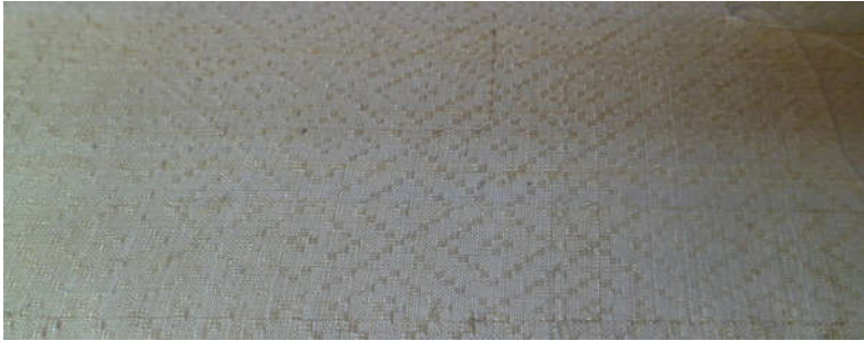
ภาพที่ 3 ผ้าลายลูกแก้ว ด้านบนขณะทอบนกี่ทอผ้า ฟืม 5 เขา 2 เอื้อ
