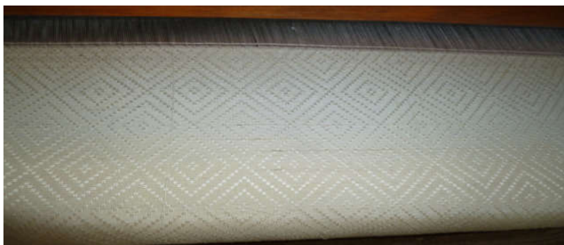
ภาพที่ 9 ผ้าลายลูกแก้ว พิมพ์ 5 เขว 3 เอื้อ เขาหนาอยู่หน้าเขาชิดด้านบนเป็น ลายเส้นยืนด้านล่างเป็นลายเส้นพุ่ง
