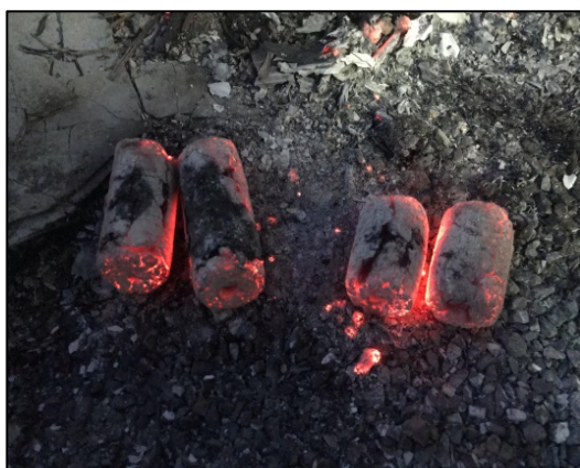
ภาพที่ 6 การทดสอบการเผาไหม้ถ่านอัดแท่งจากเศษกระจุต
