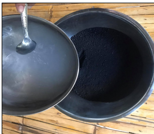
ภาพที่ 4 การผสมผงถ่านจากเศษกระจุตกับกาวแป้งเปียก
