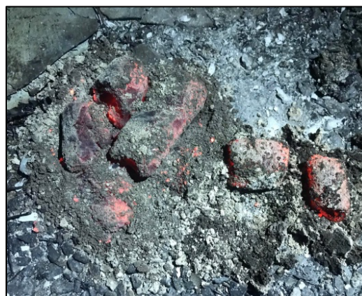
ภาพที่ 6 การทดสอบการเผาไหม้ถ่านอัดแท่งจากเศษกระจุต
