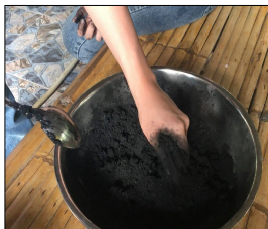
ภาพที่ 4 การผสมผงถ่านจากเศษกระจุตกับกาวแป้งเปียก
