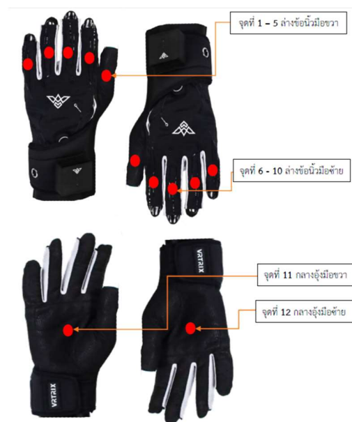
ภาพที่ 5 ตำแหน่งเซ็นเซอร์สำเร็จรูปที่ถูกติดตั้งบน ถุงมือสวมใส่
