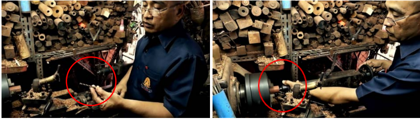
ภาพที่ 6: การใช้ดอกสว่าน 2 หุน แบบสั้นและแบบยาว เจาะส่วนบนของไม้กำพวด
