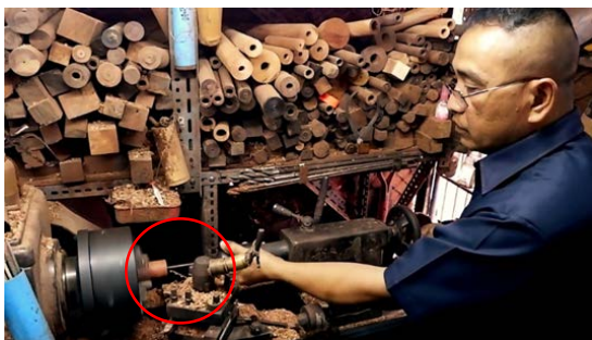
ภาพที่ 5: การใช้ดอกสว่านเจาะช่องทางเดินของเสียง
