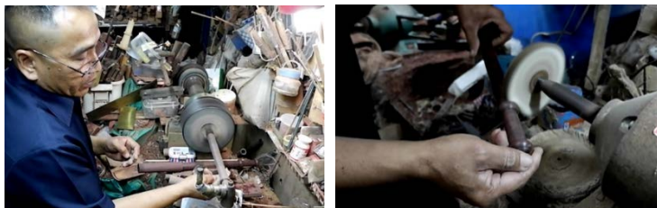
ภาพที่ 14: การใช้กระดาษทรายขัดเก็บรายละเอียด และใช้ไขมันสัตว์หรือยาแดง ขัดเงา
