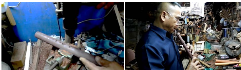
ภาพที่ 10: การเจาะรูบังคับเสียงและทดสอบเสียงเมื่อเจาะรูเสร็จ
