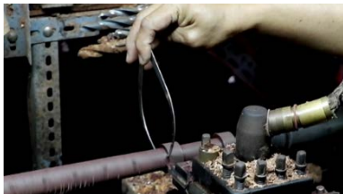
ภาพที่ 12: การใช้เครื่องมือเขาวาย กำหนดความกว้างของเลาปี ตามปีต้นแบบ
