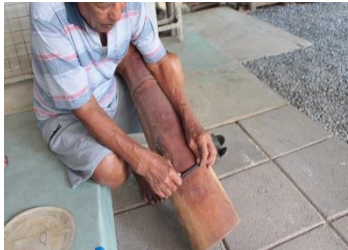
ภาพที่ 5 การวัดรอบอกทับยาวและใช้สิ่วบากร่องคอทับยาวสำหรับร้อยเชือก เพื่อดึงหนังหน้าทับยาว
