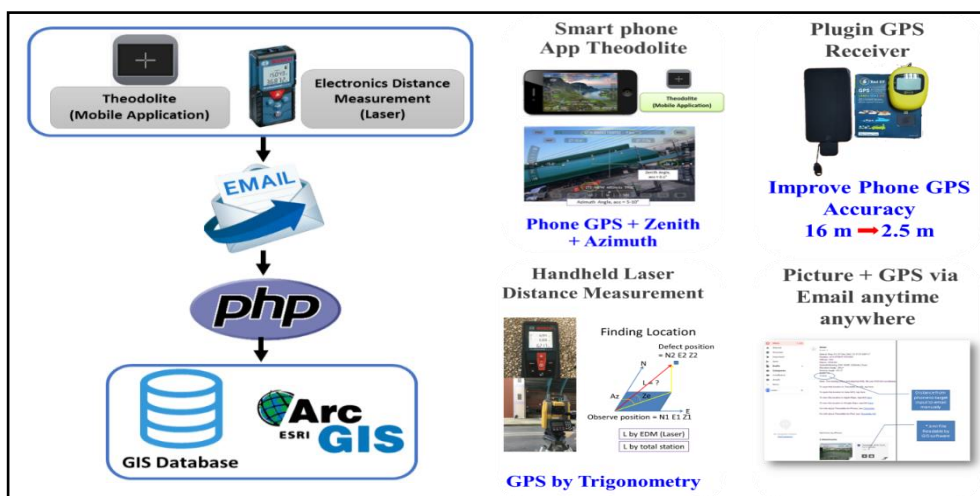
รูปที่ 6 ขั้นตอนการพัฒนาาระบบระบุตำแหน่งอุปกรณ์ของทางพิเศษโดยใช้แอปพลิเคชันบนโทรศัพท์มือถือ
