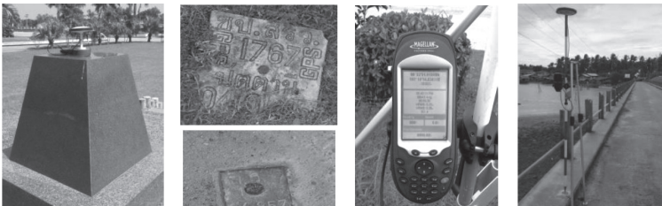
ภาพที่ 4 หมุดหลักฐานของกรมแผนที่ทหาร (ก) กรมชลประทาน (บน) และกรมที่ดิน (ล่าง) (ข) เครื่อง GPS (ค)
