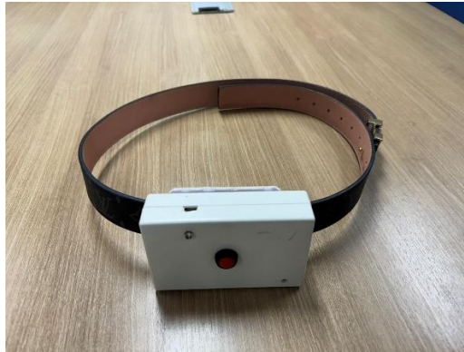
รูปภาพที่ 13 เข็มขัดและระบบแจ้งเตือนการล้มของผู้ป่วย
