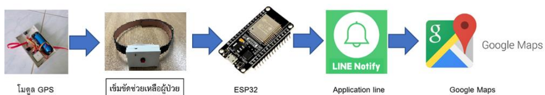
รูปภาพที่ 21 ลักษณะการทำงานของระบบ GPS ของตัวเซมิคอนดัคเตอร์
