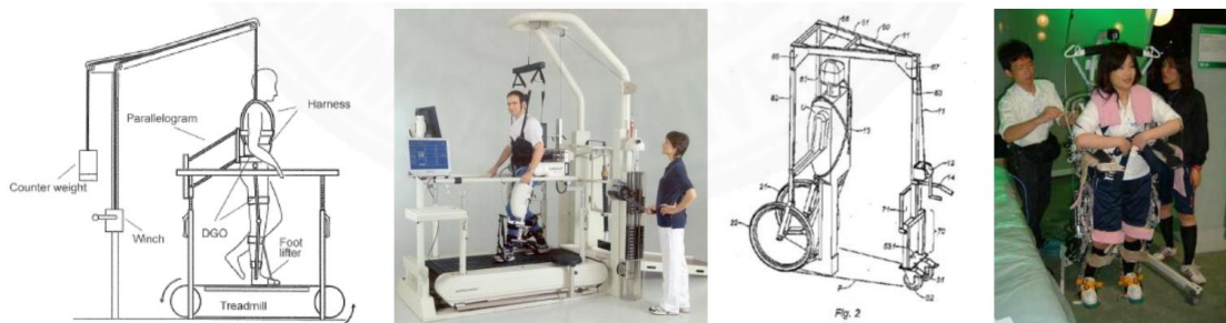
รูปภาพที่ 3 การยกตัวโดยใช้รอกดึงขึ้นในแนวตั้งฉากกับพื้นและใช้น้ำหนักถ่วงฝั่งตรงข้าม
