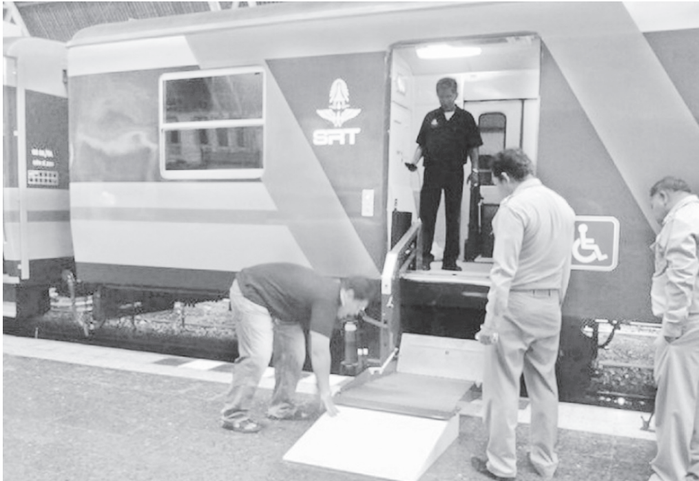
ภาพที่ 6 รถไฟสำหรับผู้พิการที่มีลิฟท์บริเวณหน้าต่างเข้าใช้สำหรับเคลื่อนย้ายขึ้นลง ระหว่างตู้ขนส่งผู้โดยสารเส้นทางกรุงเทพ-หนองคาย (ที่มา http://songkhlatoday.com/paper/93077 )
