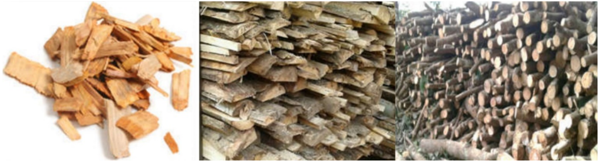
ภาพที่ 4 รูปไม้สับ ปีกไม้ ไม้พินที่ได้จากโรงงานผลิตไม้แปรรูป
