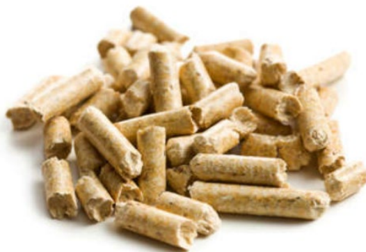
ภาพที่ 6 รูปชีวมวลอัดแท่งที่ได้จากกระบวนการอัดขึ้นรูป
