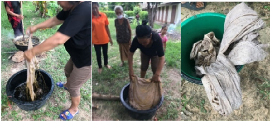
ภาพที่ 5 การล้างผ้าฝ้ายด้วยน้ำเพื่อร่อนไปหมักโคลน ที่มา : นรพล รามฤทธิ์
