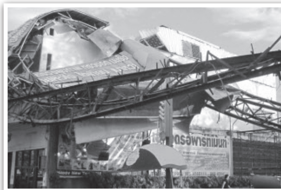
รูปที่ 1 การวิบัติของป้ายโฆษณาเนื่องจากแรงลม (www.bkknew.net และ http://www.udon-city.com)
