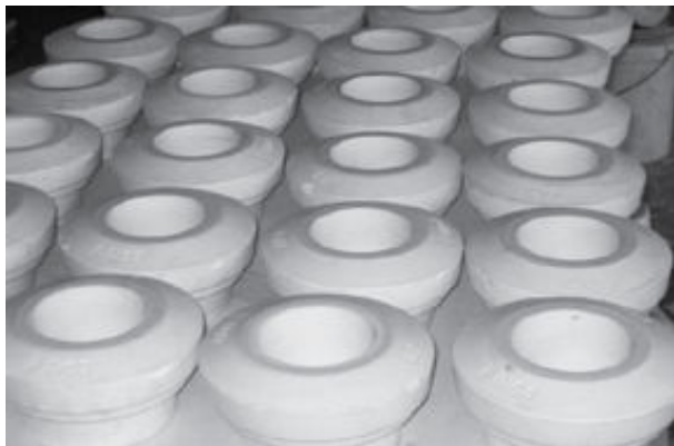
ภาพที่ 1 พิมพ์ปูนปลาสเตอร์ในอุตสาหกรรมเซรามิกส์ อายุการใช้งานประมาณ 100 – 120 ครั้งต่อพิมพ์
