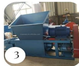
นำเศษโฟมบดไปหลอมหรืออัดการหลอมทำได้โดยใช้สกรูความร้อน
