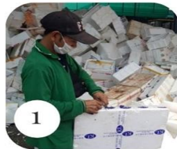
นำโฟมมาแกะแยกออกจากกล่องเพื่อง่ายต่อการนำเข้าเครื่องบด
