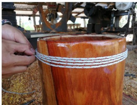
ภาพที่ 11 วัดเชือกร้อยหูหนังหน้ากลอง
