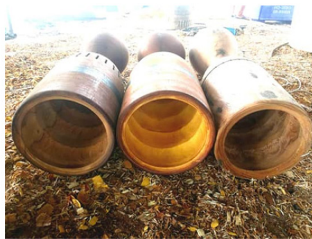
ภาพที่ 7 ลักษณะพื้นผิวภายในโพรงโดยลักษณะพื้นผิวภายในโพรงมีลักษณะเป็นคลื่นหรือเป็นเกลียว
