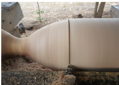
ภาพที่ 3 กลองยาวอีสานลักษณะที่เป็นแบบเอวคอด และการเจาะร่องลวดรัดอก
