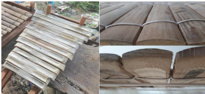
ภาพที่ 3 ไม้ไผ่ที่ตัดทำลูกระนาดและวิธีการใช้เชือกผูกลูกระนาด
