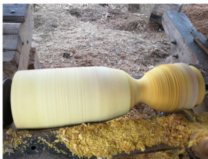
ภาพที่ 2 การกลึงไม้ เพื่อขึ้นรูปกลองยาวอีสาน
