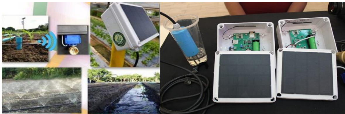
แผนภาพที่ 5 (a) ระบบจ่ายน้ำทางการเกษตรแบบแม่นยำอัตโนมัติด้วยเทคโนโลยี IoT sensor และ (b) แผงโซลาร์เซลล์ขนาดเล็กต้นกำเนิดพลังงาน
