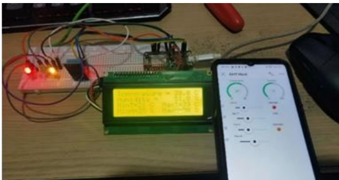
ภาพที่ 2 การต่อวงจรและการตั้งค่าอุณหภูมิและความชื้นผ่านทาง Smart Phone
