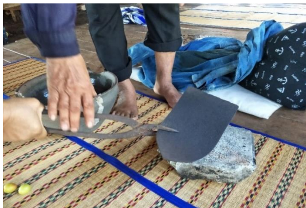
รูปที่ 8 ใช้เหล็กคืบ คืบเหล็กผานที่ร้อนระอุ
