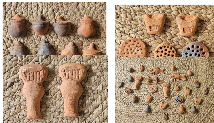
ภาพที่ 8 ผลิตภัณฑ์ที่ได้จากการพิมพ์ปูนดำที่ผ่านการเผาที่อุณหภูมิ 900 องศาเซลเซียส
