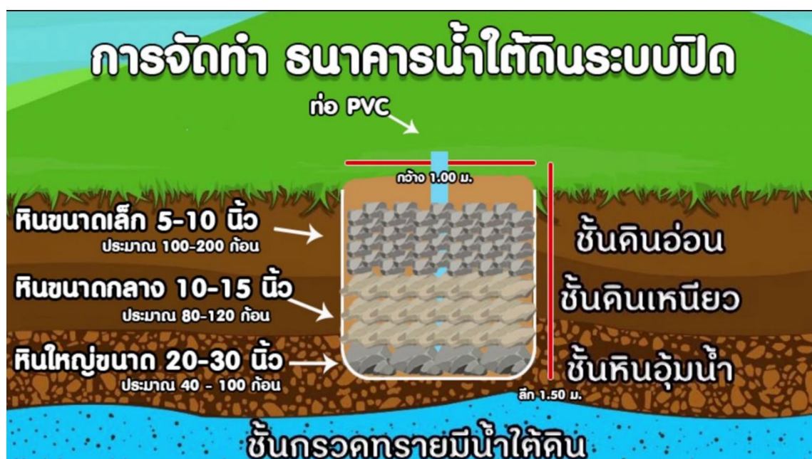
ภาพที่ 2 ธนาคารน้ำใต้ดินระบบปิดในที่อยู่อาศัย
